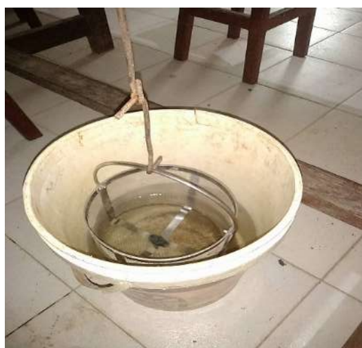
Gambar 5. Sampel yang ditimbang tergantung
