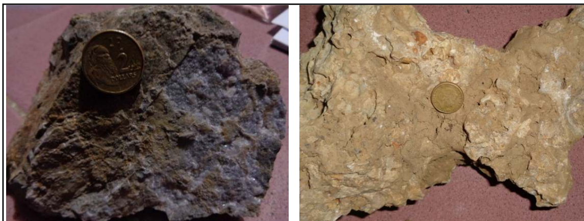
Gambar 6. Batugamping yang terdapat di distrik Windesi: batugamping kristalin (kiri); batugamping terumbu (kanan)
