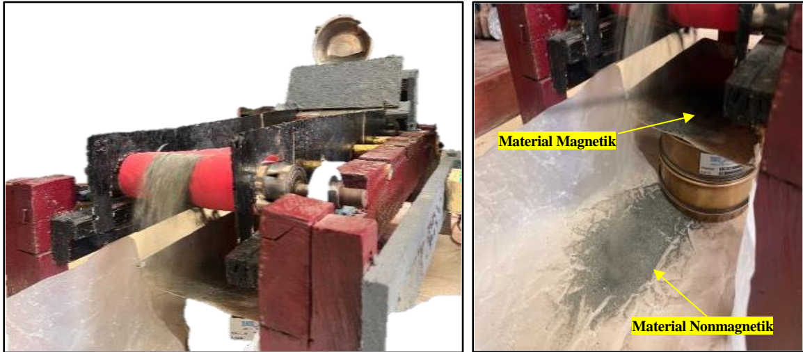
Gambar 1. Proses pemisahan material magnetik dan nonmagnetik pasir menggunakan prototipe magnetic separator
