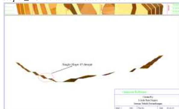
Gambar 5. Section Pit dengan Single Slope 45°
