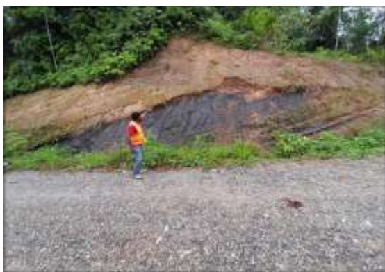
Gambar 6. Singkapan batulempung sisipan batubara, dan kontak menjemari antara batulempung dan batupasir
